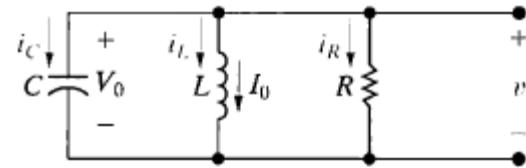
$$R_3 := 2\text{k}\Omega \quad L_3 := 250\text{mH} \quad C_3 := 10\text{nF}$$
