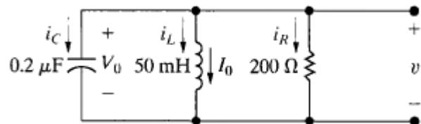
$$i_L(t) \cdot \frac{\text{mH}}{\text{V}\cdot\text{s}} \cdot \frac{\text{mA}}{10^{-6}} \text{ expand } \rightarrow 56 \cdot \text{mA} \cdot e^{-\frac{5000 \cdot t}{\text{s}}} - 26 \cdot \text{mA} \cdot e^{-\frac{20000 \cdot t}{\text{s}}}$$
