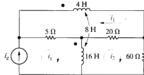
$$8H \cdot \frac{d}{dt} i_1(t) - 20 \cdot \Omega \cdot i_1(t) + 16 \cdot H \cdot \frac{d}{dt} i_2(t) + 800 \cdot \Omega \cdot i_2(t) = -16 \cdot H \cdot \frac{d}{dt} i_g(t)$$
